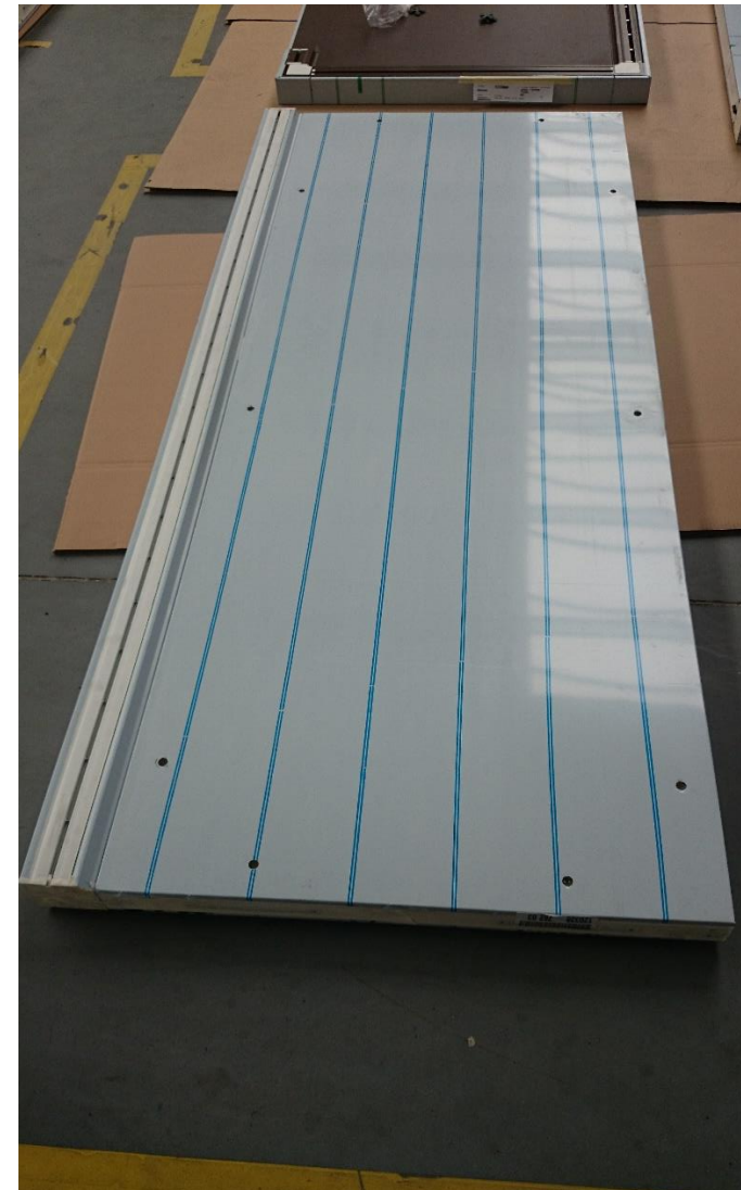
Fot 10. Czesci korpusu – sciana prawa ze słupkiem narożnikowym.
