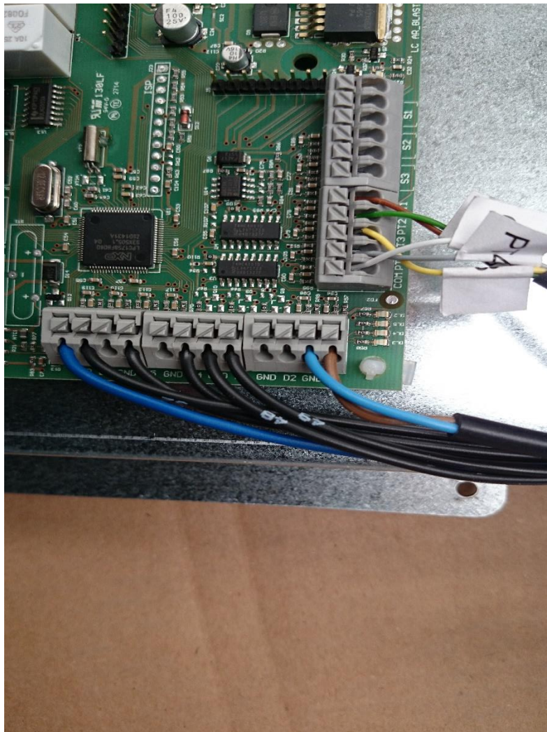
Fot 35. Miejsce podłączenia czujnika GND/D2 otwarcia drzwi na płycie sterującej.
