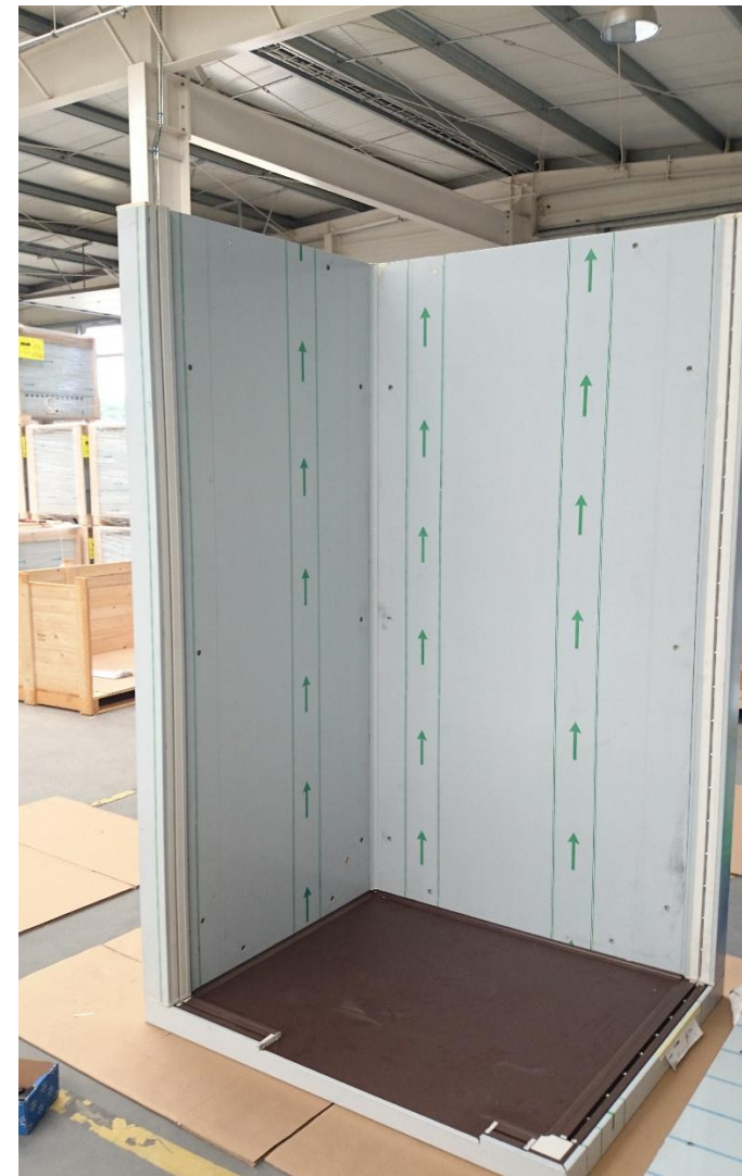
Fot 14. Czesci korpusu – zamocowane sciany tylna i lewa.
