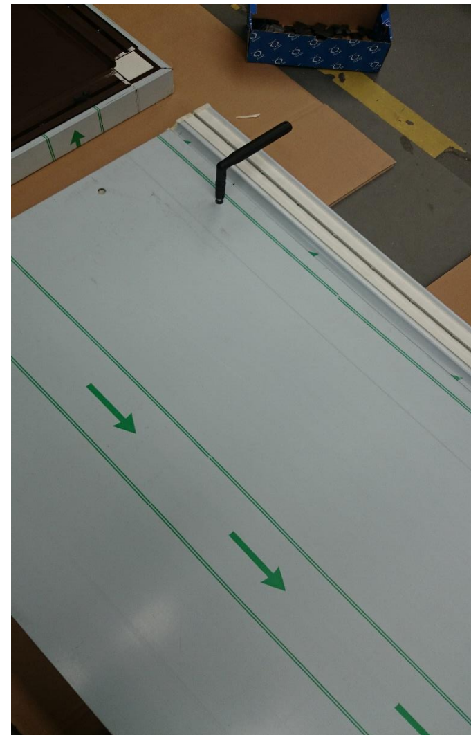
Fot 12. Czesci korpusu – blokowanie przy pomocy klucza szesciokatnego.
