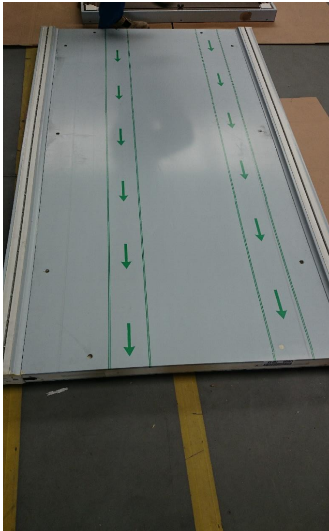
Fot 9. Czesci korpusu – sciana tylna ze slupkami narożnikowymi.
