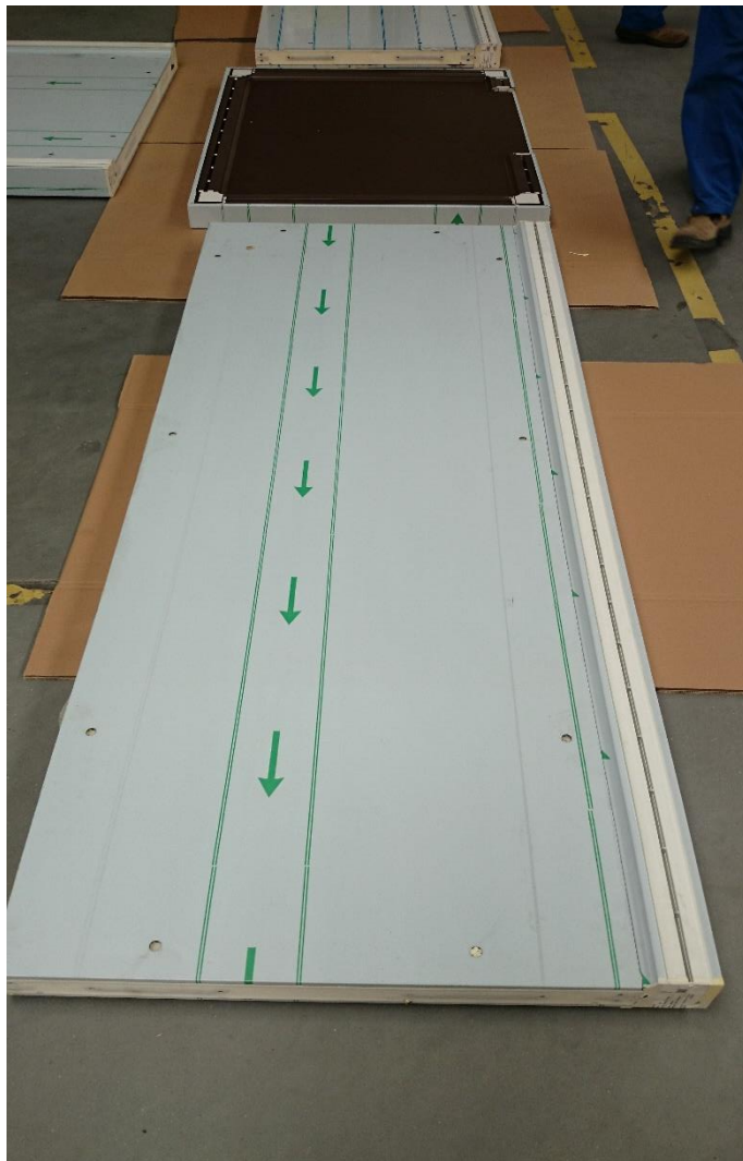
Fot 11. Czesci korpusu – sciana lewa ze słupkiem narożnikowym.
